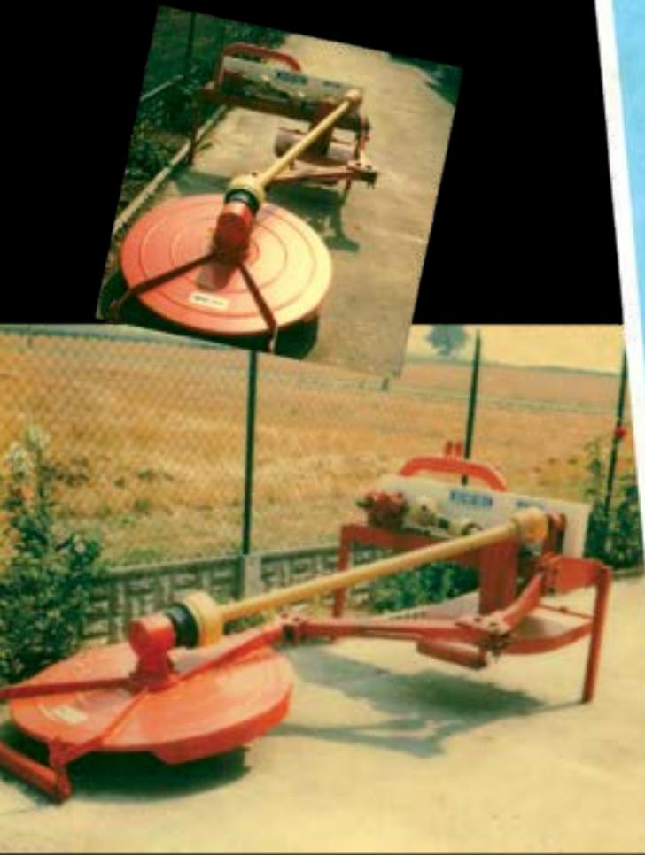
Mediante un sistema autoelevante, non necessitano di un continuo adattamento al terreno e raggiungono un'inclinazione di oltre 70° per un'accurata pulizia di fossi e cunette.
