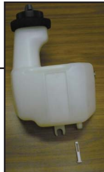
filtre sous le réservoir filter below tank
